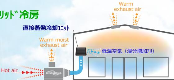
Climate Wizard™は、他の直接蒸発冷却ユニット、様々な負荷、快適性への課題をうまく解決するために温水コイル、ガス燃焼熱交換器などの暖房装置等の補助機器と共に使用されます。
