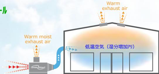
Climate Wizard™スーパークールは、加湿した低温空気を給気、これによって室内を設計仕様にマッチした温湿度に調整することができます。
