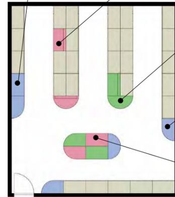
半円型ベンチは背中合わせのロッカー側面に設置できます。側面のスペースを有効活用できます。
