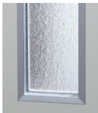
アルミ押出型材使用 白色アルマイト仕上げ ●適応ガラス厚 4.0、5.0、6.8mm ●コーキング仕上 (ガラス工事)
