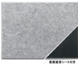
音の「漏れ」や「侵入」を防ぐためには、遮音が必要です。音が気になる壁面をしっかりと覆うように遮音材を取り付けることがとても重要になってきます。防音フェルトボードは硬質吸音ボードの背面に遮音シートが貼り付けられていますので、吸音+遮音の2つの効果で防音性を高めます。壁面をしっかりと覆うように取り付けることで、遮音効果を高める事ができます。
