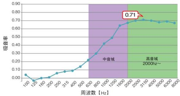
中音域から大きく上昇し、1250Hz時点で0.5の吸音率、2000Hz以降は約0.7の吸音率で、中～高音域に対する吸音効果が高いことが伺えます。
